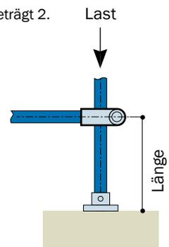
Tabelle 27 gibt nur Hinweise auf die zulässige Beanspruchung in Kilogramm, die bezüglich der oben genannten Einschränkungen von einzelnen Aluminiumrohren gemäß DIN EN 755 getragen werden dürfen, wenn sie als Pfosten verwendet werden.
