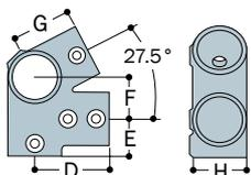
Typ 350 ist für kleinere gebäudeähnliche Konstruktionen, wie z. B. Gewächshäuser, geeignet und gewährleistet ausgezeichnete Belastungswerte. Bei der Verwendung in Verbindung mit Typ 351 kann eine zusätzliche Querverbindung eingebaut werden. Zwei Stellschrauben am Sockel der Querverbindung sorgen für einen hohen Auszugswiderstand und somit für eine stabile Konstruktion.
