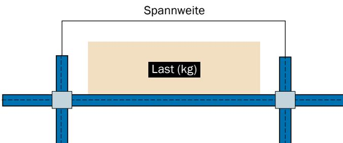
Tabelle 23 gibt eine Übersicht über die zulässige Beanspruchung in Kilogramm, die unter Beachtung der vorgenannten Einschränkungen von einzelnen Rohren nach DIN EN 10255 (ISO 65) getragen werden dürfen, wenn sie als Pfosten verwendet werden.
