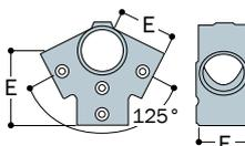
Typ 351 ist für kleinere gebäudeähnliche Konstruktionen, wie z. B. Gewächshäuser, geeignet und gewährleistet ausgezeichnete Belastungswerte. Bei der Verwendung in Verbindung mit Typ 350 kann eine zusätzliche senkrechte Stützverbindung eingebaut werden. Zwei Stellschrauben am Sockel der senkrechten Stützverbindung sorgen für einen hohen Auszugswiderstand und somit für eine stabile Konstruktion.
