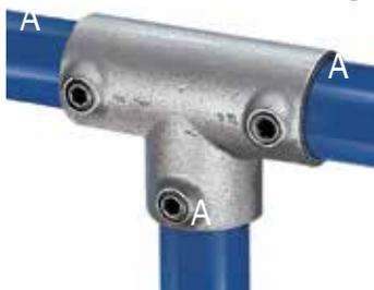
Häufig genutzter Rohrverbinder für 90 Grad-Verbindungen zwischen dem Handlauf und dem Zwischenpfosten eines Sicherheitsgeländers. Da in der Waagerechten mit zwei Innensechskant-Stellschrauben ausgestattet, kann dieser Rohrverbinder für die Erstellung horizontaler Rohrverbindungen verwendet werden. Als Alternative zu Typ 25 bietet sich Rohrverbinder Typ 10 in seiner senkrechten Position an.
