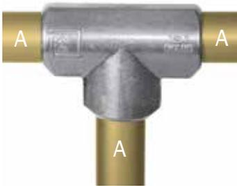
Häufig genutzter Rohrverbinder für 90°-Verbindungen zwischen dem Handlauf und dem Zwischenpfosten eines Sicherheitsgeländers. Da in der Waagerechten mit zwei Innensechskant-Stellschrauben ausgestattet, kann dieser Rohrverbinder für die Erstellung horizontaler Rohrverbindungen verwendet werden. Als Alternative zu Typ L25 bietet sich Rohrverbinder Typ L10 an. Typ L25 ist aber immer dann zu verwenden, wenn eine Verbindung zwischen zwei Rohren erfolgen soll.
