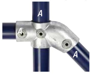
Eine Querverbindung, die für den Einsatz an Handläufen mit Gefälle und in Treppenhäusern mit einem Winkel von 30° bis 45° am Übergang von der Geraden in das Gefälle treppab- oder aufwärts geeignet ist.
