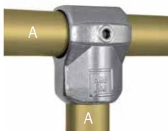
Dieser Rohrverbinder erlaubt den 90°-Anschluss zweier Rohre. Er wird häufig zur Verbindung zwischen Endpfosten und Knielauf von Sicherheitsgeländern auf geradem, ebenem Boden verwendet. Dieser Typ kann nicht eingesetzt werden, wenn das durch die Muffe 'A' verlaufende Rohr innerhalb des Verbinders verbunden werden muss.
