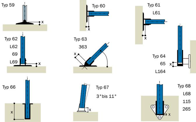
Tabelle 13 enthält Angaben über die Abmessung 'x' der Bodenbefestigung, die von der Höhe 'H' abzuziehen ist, um die Länge des Pfostens 'h' zu erhalten.
