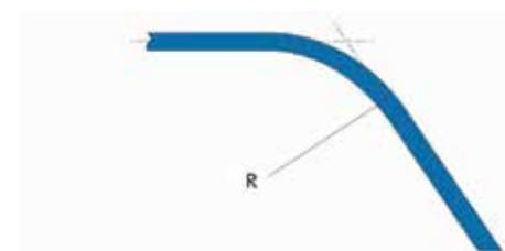
Tabelle 21 informiert über Details zu Standardradien 'R' der Rohrbiegung durch die Kee Safety Ltd. Sollten diese Standardradien nicht passen, kann Rohr der Größen 5 bis 9 ab einem Minimum von 500mm in jedem beliebigen Radius gebogen werden.
