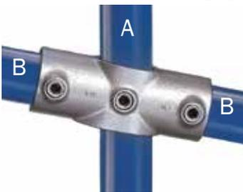
Typ 89 wird für die Verbindung des Knielaufs mit dem Mittelpfosten eines Sicherheitsgeländers eingesetzt. Er ermöglicht den Ausgleich von Neigungswinkeln von 0° bis 11°.
