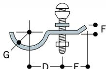
Zum Lieferumfang gehören eine Sechskantschraube M6 x 50 mm mit Mutter sowie ein Dichtring. Ø gibt den Durchmesser der Bohrung an.
