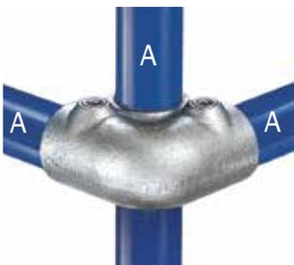
Typ 121 ergibt eine um 90° versetzte Eckverbindung. Zur genauen Berechnung der Schnittlängen für das Rohr muss die Abmessung "G" abgezogen werden. Außerdem ist die Abmessung "H" zu addieren um die Rohrlänge für den Pfosten zu erhalten.
