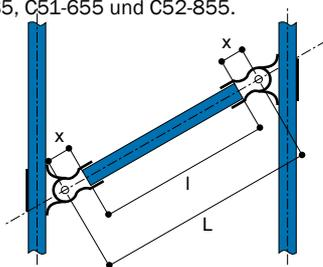
Tabelle 10 enthält Angaben über Abmessung 'x', die abgezogen ist, um die zur Verwendung mit dem Rohrverbinder F50 oder LF50 erforderliche Rohrlänge in der Formel  $I = L - 2x$  zu erhalten.
