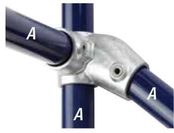
Rechtes T-Stück mit seitlichem Abgang, das für den Einsatz an Handläufen mit Gefälle und in Treppenhäusern mit einem Winkel von 30° bis 45° am Übergang von der Geraden in das Gefälle treppabwärts geeignet ist.
