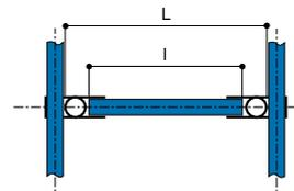
Tabelle 11 enthält Abmessung 'x', die von der Gesamtbreite der Querrohre abgezogen ist, um die Länge der Querstangen in der Formel  $I = L - x$  zu erhalten.
